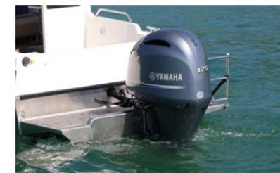
Die Cabin E ist für eine Aussenborder-Motorisierung bis 250 PS zugelassen. Das Testboot war «nur» mit einem Yamaha F 175 CET motorisiert – überzeugte damit aber vollauf. Das Boot kam schon bei knapp 3000 Touren in die stabile Gleitfahrt, die Spitzengeschwindigkeit bei 6000 Touren betrug 66 km/h. Die zusätzlichen PS könnten nur bei massiver Beladung allenfalls fehlen.
