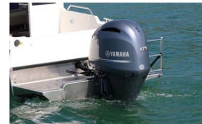
Le Cabin E est homologué pour une motorisation hors-bord jusqu'à 250 cv. Bien qu'il n'était équipé «que» d'un Yamaha F 175 CET, le bateau testé s'est révélé tout à fait convaincant en déjaugant déjà à près de 3000 tours et en affichant une vitesse de pointe 66 km/h à 6000 tours. Ce n'est qu'en cas de charge extrême que les cv supplémentaires pourraient venir à manquer.
