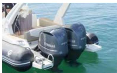
Selon le constructeur, la motorisation maximale est de 450 cv. Une puissance délivrée précisément par les deux Yamaha F225. Pour un bateau de presque 3000 kg, la puissance totale de 450 cv s'est avérée être la configuration idéale lors du test. Les deux moteurs fournissent une forte accélération et offrent suffisamment de réserve même dans la plage de vitesse supérieure.
