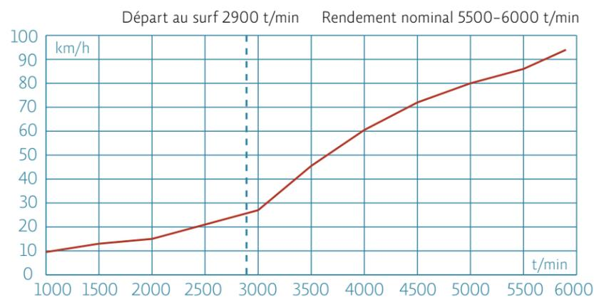
Point mort: 600 t/min, Vitesse maximale: 94 km/h pour 5900 t/min. Mesuré sur le lac de Neuchâtel, avec GPS, 2 personnes à bord, aucun vent et aucune vague.
