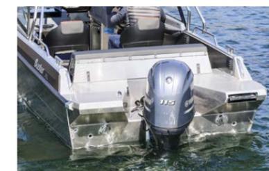
Die Buster XL ist für eine Aussenborder-Motorisierung bis 110 PS zugelassen. Das Testboot war entsprechend mit einem Yamaha F115 XB motorisiert und überzeugte damit vollauf. Das Boot kam schon bei knapp 3000 Touren in eine stabile Gleitfahrt, die Spitzengeschwindigkeit bei 5800 Touren betrug knapp 65 km/h. Und das bei ziemlich starker Bise und Wellen...
