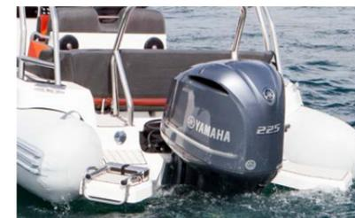
Für den Test war das Zodiac Medline 6.8 mit einem Yamaha F225FETX ausgestattet. Die 225 PS brachten das Boot schon bei etwa 2800 Touren in eine solide Gleitfahrt. Die kontinuierliche Steigerung der Geschwindigkeit bietet anschliessend noch ein grosses Spass-Potenzial. Wichtig ist allerdings, dass sich alle an Bord festhalten – die Fliehkräfte sind nicht zu unterschätzen!
