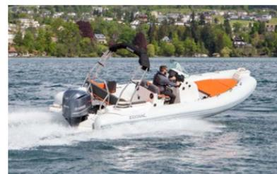
Fehlende Spurtreue und schlechtes Kurvenverhalten? Fehlanzeige! Dank markantem V-Rumpf mit ausgeprägten Kimmkanten und grossem Schlauchkörper sind auch Wellen für das Medline 6.8 kein Problem. Ein weiterer Vorteil ist das geringe Gewicht: Die hohe Spitzengeschwindigkeit von fast 90 km/h und die kaum spürbaren Schläge sind eine direkte Folge davon.
