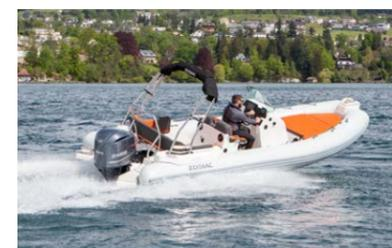
Manque de stabilité de cap et mauvais comportement dans les virages? Grâce à la coque en V dotée de bouchains prononcés et aux grands flotteurs, même les plus grosses vagues ne posent aucun problème au Medline 6.8. Un autre avantage de ce dernier est son faible poids: sa grande vitesse de pointe de près de 90 km/h et les à-coups à peine perceptibles en sont la conséquence directe.
