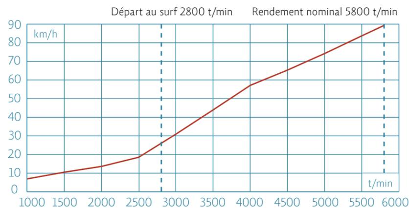
Point mort: 500 t/min, Vitesse maximale: 89,3 km/h pour 5750 t/min. Mesuré sur le lac des Quatre-Cantons, avec GPS, 2 personnes à bord, vent forçant.
