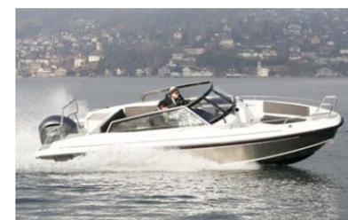
Gute Beschleunigung, sichere Fahrt und ein hervorragendes Kurvenverhalten: Die Yamarin Cross 75 BR bestätigt die Erwartungen und verfügt über tolle Fahreigenschaften. Viel zum Komfort tragen die hydraulische Steuerung und die elektronische Schaltung bei. Ebenfalls zum Standard gehören die Trimmklappen, mit denen eine ungleichmässige Gewichtsverteilung korrigiert werden kann.
