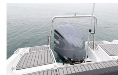
Die Yamarin Cross 75 BR ist für eine Ausenbordmotorisierung mit maximal 300 PS zugelassen. Beim Test mit einem Yamaha F300 zeigte sich, dass das Boot mit dieser geballten Ladung Kraft umzugehen weiss. Die Spitzengeschwindigkeit lag bei über 90 km/h, und trotzdem kam nie das Gefühl einer Übermotorisierung auf. Allerdings würden wohl auch 200 PS ausreichen...
