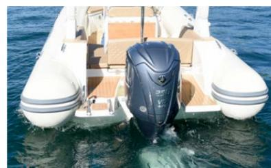
Das Testboot war mit einem Yamaha F250 ausgestattet. Und zwar einem Modell, das vollständig elektrisch angesteuert wird – da ist nirgendwo Hydraulik im Spiel und somit auch kein Tropfen Hydrauliköl. Einiges lässt sich per Knopfdruck übersteuern – im Standgas per Tempomat die Geschwindigkeit zu regeln, schafft die Elektronik besser als eine Hand am Leistungshebel.
