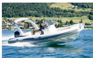
Avec le Capelli 775 et ses 250 cv à l'arrière – contrôlés électriquement –, même les débutants s'en sortent sans souci: le bateau se laisse piloter avec une facilité déconcertante à toutes les vitesses et dans tous types de virages, et ce, grâce au mariage réussi d'un concept de bateau pneumatique docile et large avec une carène en V prononcé à l'avant et dotée de plusieurs bouchains.
