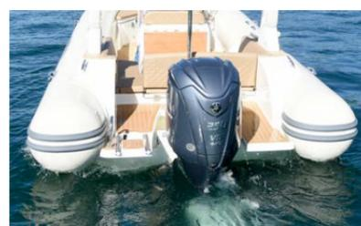
Le bateau testé était équipé d'un hors-bord Yamaha F250NSB de 250 cv, un modèle à commande entièrement électrique. Certains systèmes automatiques tels que le trim peuvent être activés sur pression d'un bouton. Pour le réglage de la vitesse au point mort via le régulateur, l'électronique s'avère plus efficace qu'une main sur le levier de vitesse.
