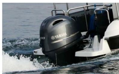
Das Testboot war mit einem Yamaha F100XB ausgestattet – zugelassen wäre vom Hersteller eine maximale Motorisierung mit 150 PS. Die gute Beschleunigung, die angenehme Gleitfahrt mit knapp 20 km/h bei 3500 Touren und die Spitzengeschwindigkeit von rund 55 km/h bei 6000 Touren zeigten jedoch, dass 100 PS keineswegs zu wenig sind.
